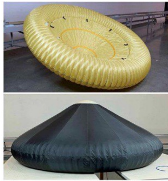
Schichtverbund aus keramischen Geweben und Graphitschäumen für ausfaltbare Hitzeschutzschilder, www.efesto-project.eu
