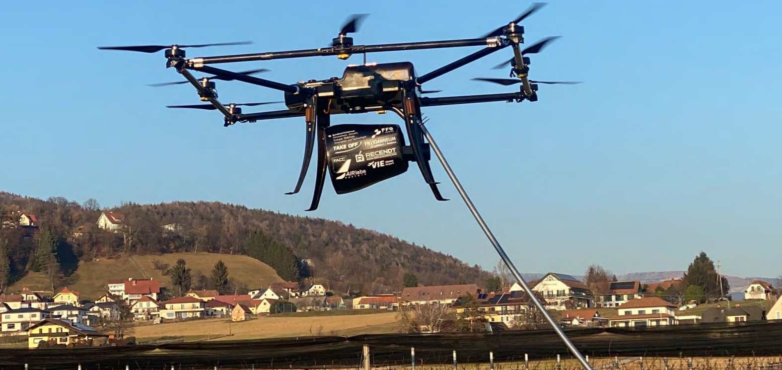
UAV-Plattform mit Gimbal zur Stabilisierung des Sensorsystems für die Laser-Ultraschallmessungen im Projekt LAUDENT. ©FH JOANNEUM
