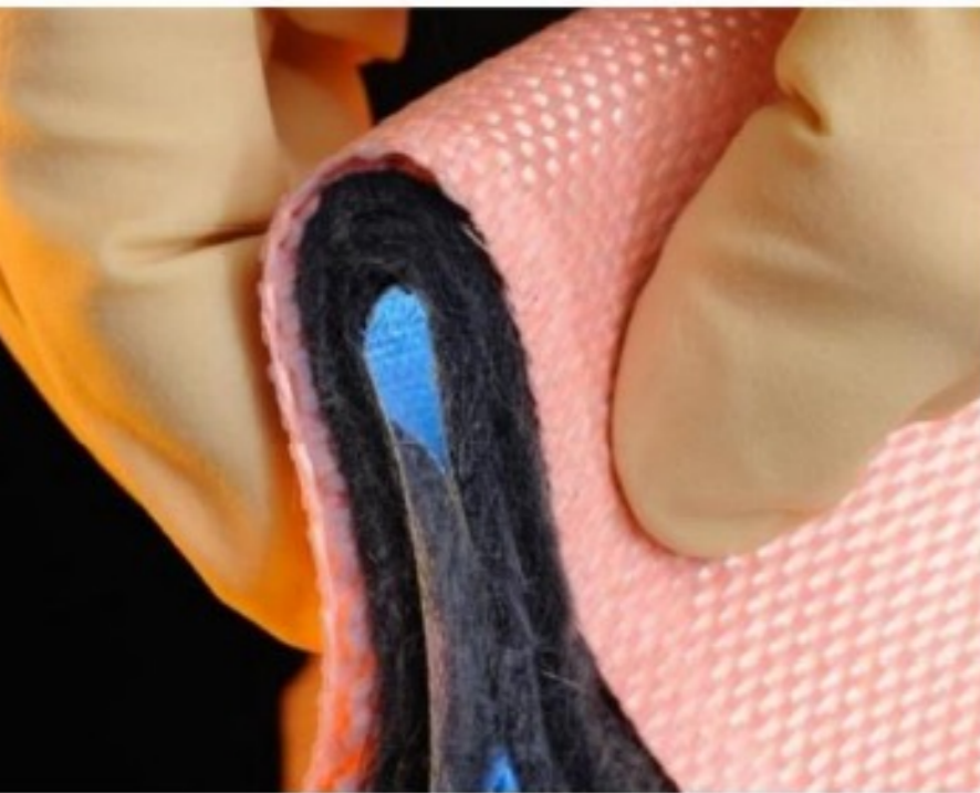
Schichtverbund aus keramischen Geweben und Graphitschäumen für ausfaltbare Hitzeschutzschilder, www.efesto-project.eu
