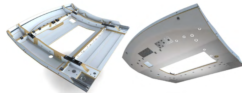
Konstruktionsstand Fahrwerksverkleidung aus Holzschichtverbund
