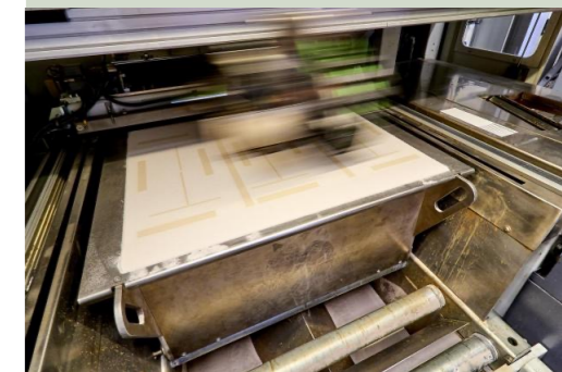
Auftrag des Bindemittels mittels 3D-Drucker auf eine Sandschicht.
